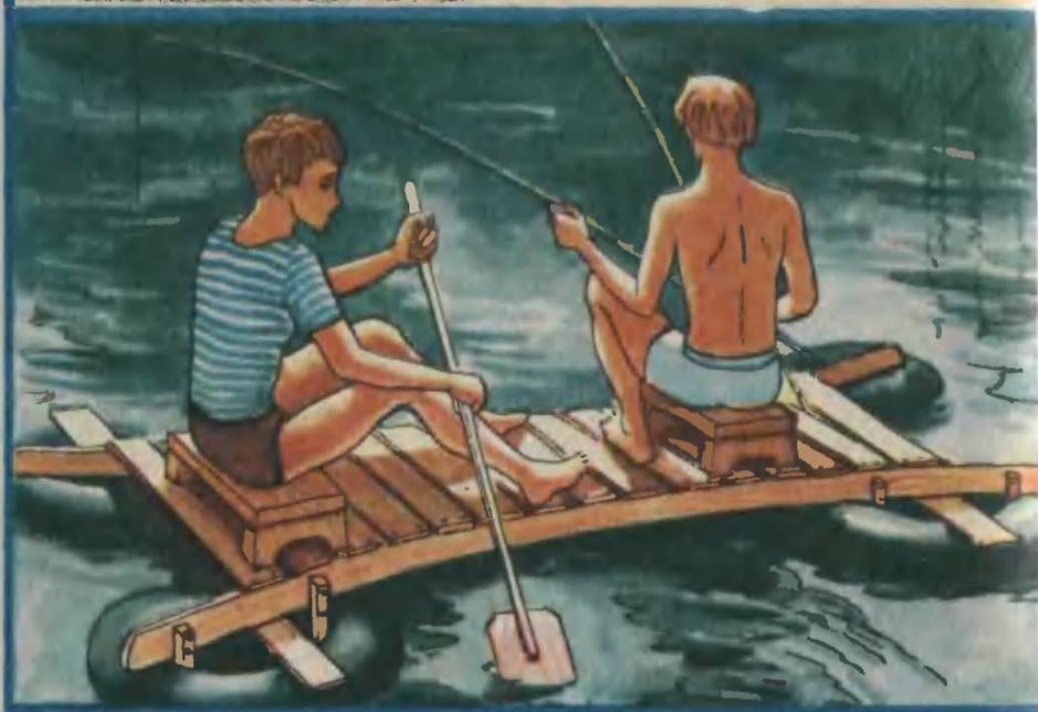
Не раз мы предлагали использовать для «малой навигации» старые автомобильные камеры. Сегодня знакомим еще с одной конструкцией — многоцелевым плотом. Сделать его легко, и по вашему желанию плот сможет послужить и спортивным снарядом, и моторной лодкой, и пляжем на воде, и уголком рыбакова.
